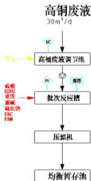
图 4-5 高铜高 COD 废液处理系统
